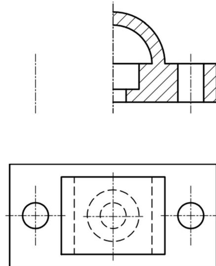
1. Completamos la parte faltante sin seccionar, tiene que ser totalmente simétrica a la dada.
