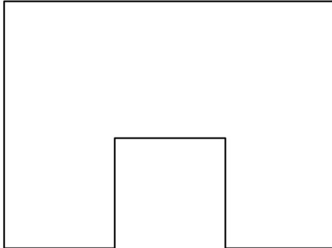
1. Como nos dan que todos los faldones de cubierta tienen una inclinación de  $30^\circ$ , podremos resolver la cubierta mediante bisectrices.
