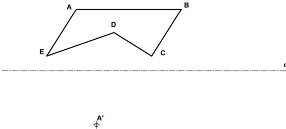
1. Primero obtenemos la dirección de afinidad, para ello unimos A con A'. Trazamos paralelas por cada punto para obtener el afín de cada uno del resto de puntos.
