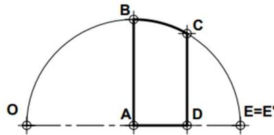
1. Tenemos una inversión directa, utilizaremos la circunferencia de puntos dobles ya que mediante arco capaz de  $90^\circ$  podremos encontrar fácilmente el inverso de un punto mediante rectas tangentes a esta circunferencia.
